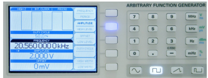
Abb. 4.5: Frontansicht mit Anzeige für die geänderte Amplituden-einstellung
