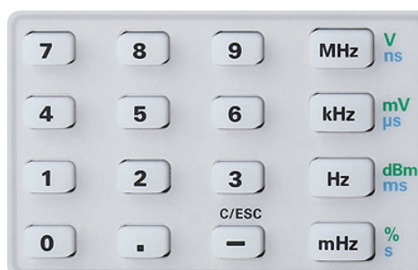
Abb. 4.2: Numerische Tastatur mit Einheiten und ESC Tasten
