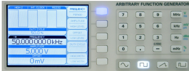
Abb. 4.3: Frontansicht mit Anzeige für die gewählte Einstellung
