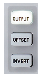
Abb. 6.1: Bedienfeld für Ausgang, Offset und Invert-Funktion
